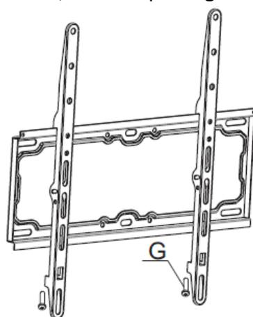
Cuelgue el televisor en la fijación de la pared y asegure que no se mueva con el tornillo tipo G, apriete con cuidado hasta encontrar la posición en que las barras queden fijas y no se desplacen.
