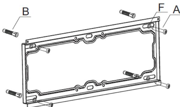
Usando el nivel de burbuja, asegúrese que la placa de pared esta nivelada, taladre dos agujeros con una broca de 10 mm y una profundidad de 50 mm. Inserte los anclajes de pared en los orificios. Luego utilice los pernos largos A y los tacos tipo B para dejar fijado a la pared la placa de sujeción principal. Recuerde colocar la arandela F entre la placa de la pared y los pernos.
